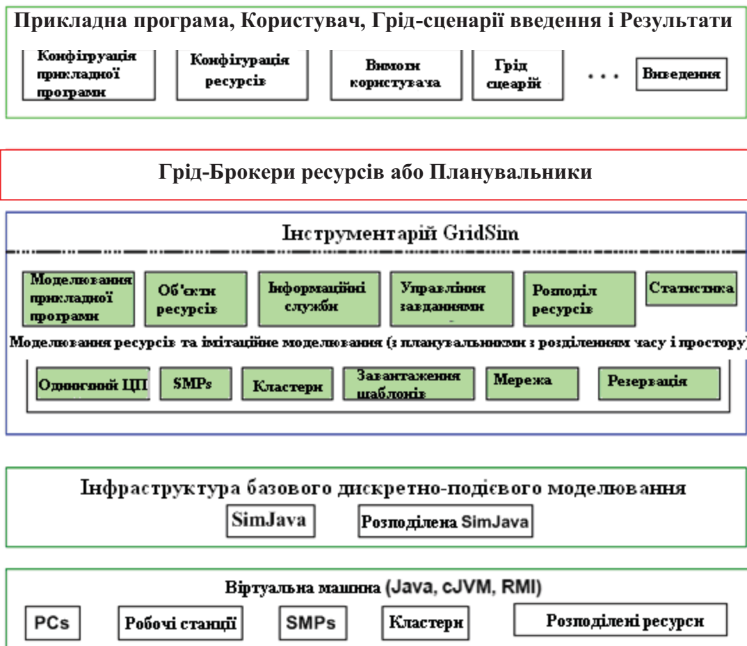
Рис. 2. Модульна архітектура GridSim платформи та її компонентів
