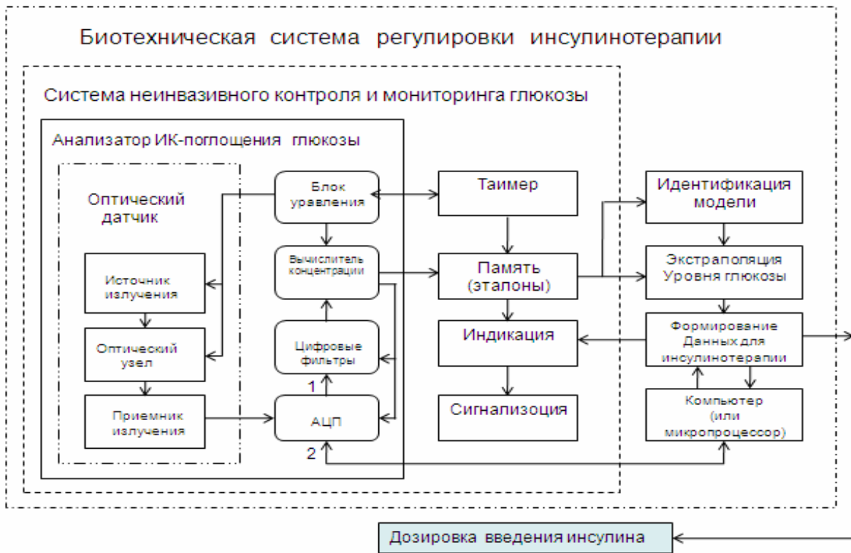
Рис. 2. Структурно-функциональная схема биотехнической системы регулирования инсулинотерапии с анализатором ИК поглощения глюкозы
