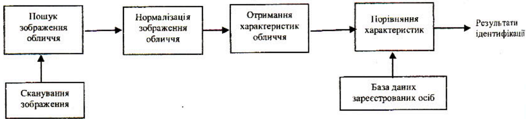
Рис. 2 — Узагальнена структурна схема системи розпізнавання
